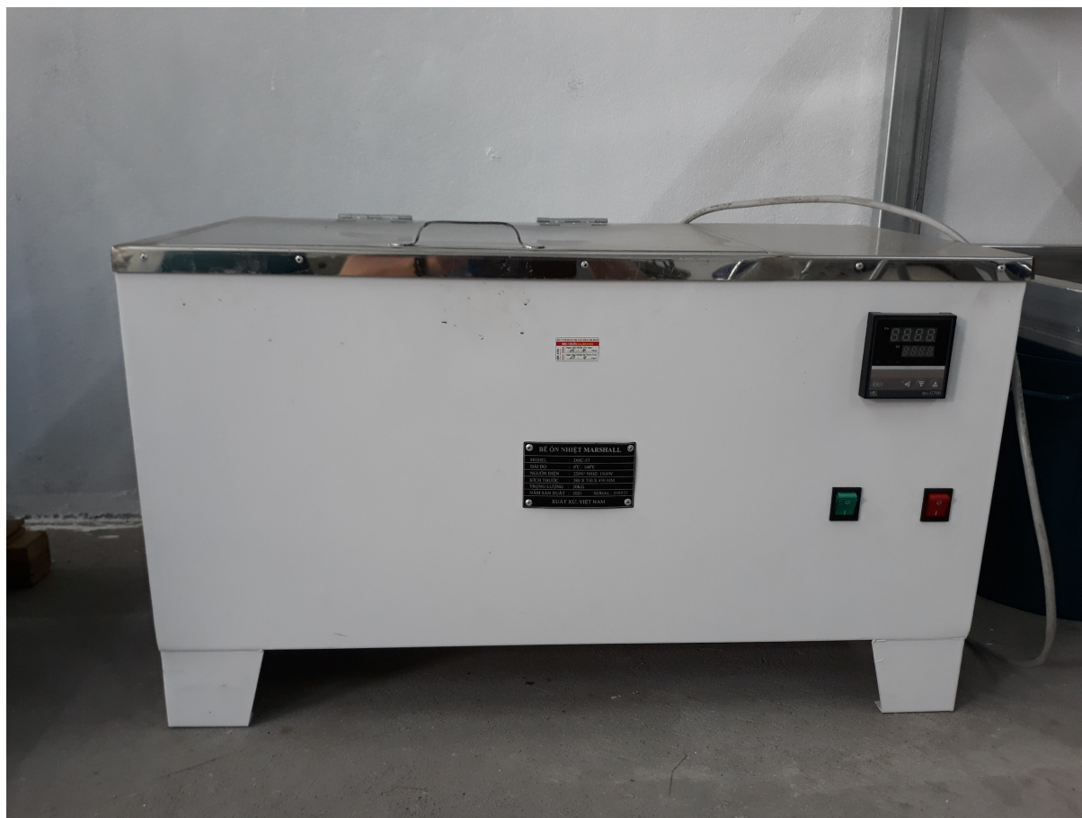
BỂ ỒN NHIỆT
